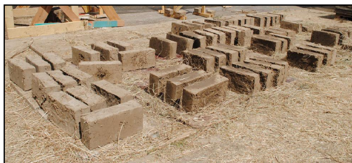
Fig.1.1: Moulage et séchage des blocs adobes (les grands voisins,2018).
