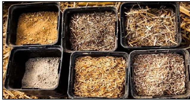
Fig. 1.2: Composition des briques de terre crue(Pierre Delot, 2015).
