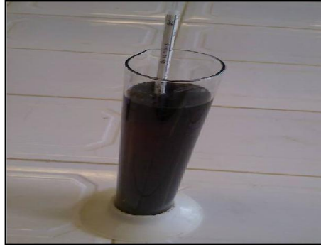
Fig.3.5. essai de densité de superplastifiant.
