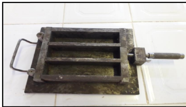
Fig. 3.10: Moule utilisé pour la fabrication des éprouvettes (flexion)
