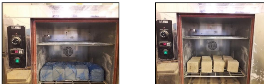
Fig. 3.16: Cure des blocs à l'étuve.
