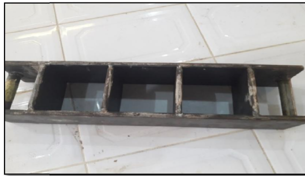
Fig. 3.9: Moule utilisé pour la fabrication des blocs (compression)
