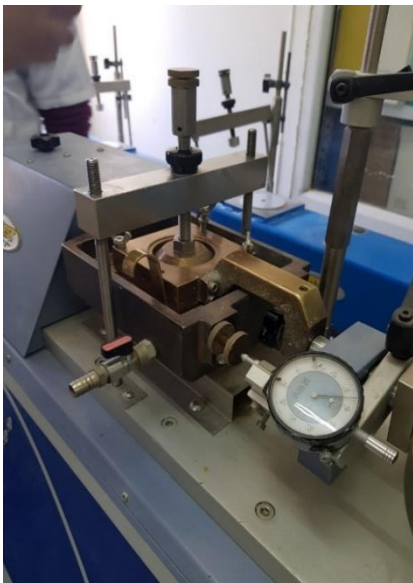
Figure 2-10 : appareil de cisaillement rectiligne à la boîte de Casagrande (LNHC Batna)
