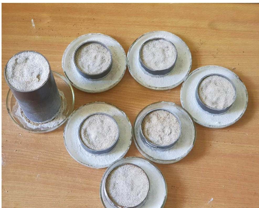
Figure 2-21 : l'échantillons après l'étuvage
