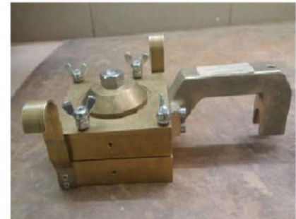
Figure 2-11 : Principe d'exécution de l'essai de cisailment
