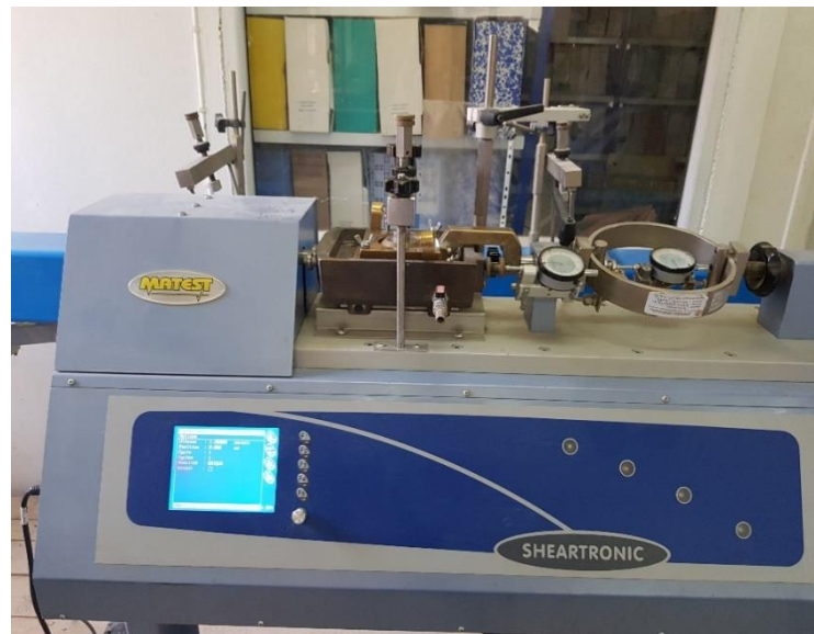
Figure 2-10 : appareil de cisaillement rectiligne à la boîte de Casagrande (LNHC Batna)
