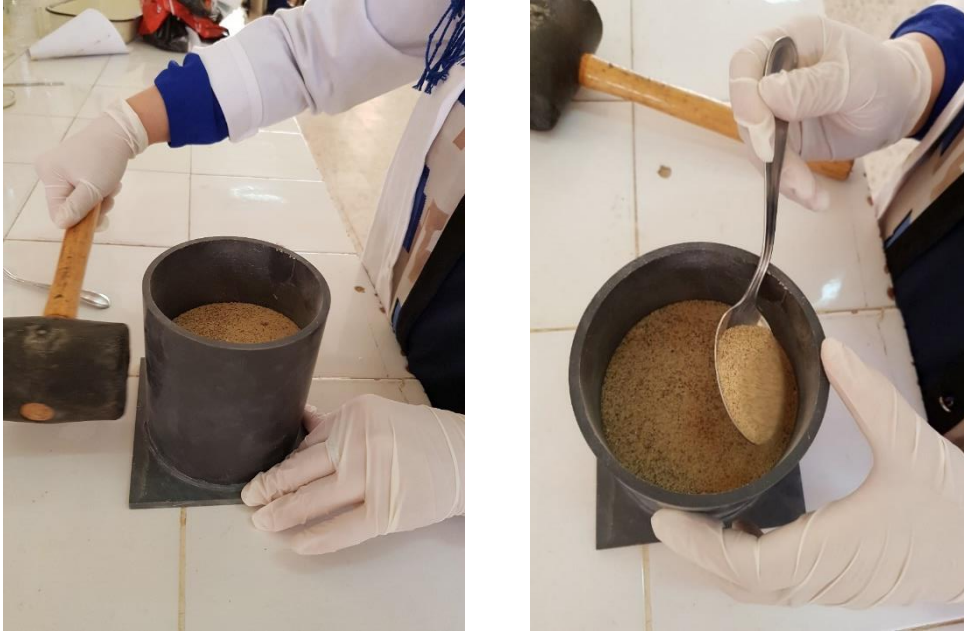
Figure 2-3 : Préparation de L'indice de vide minimum
