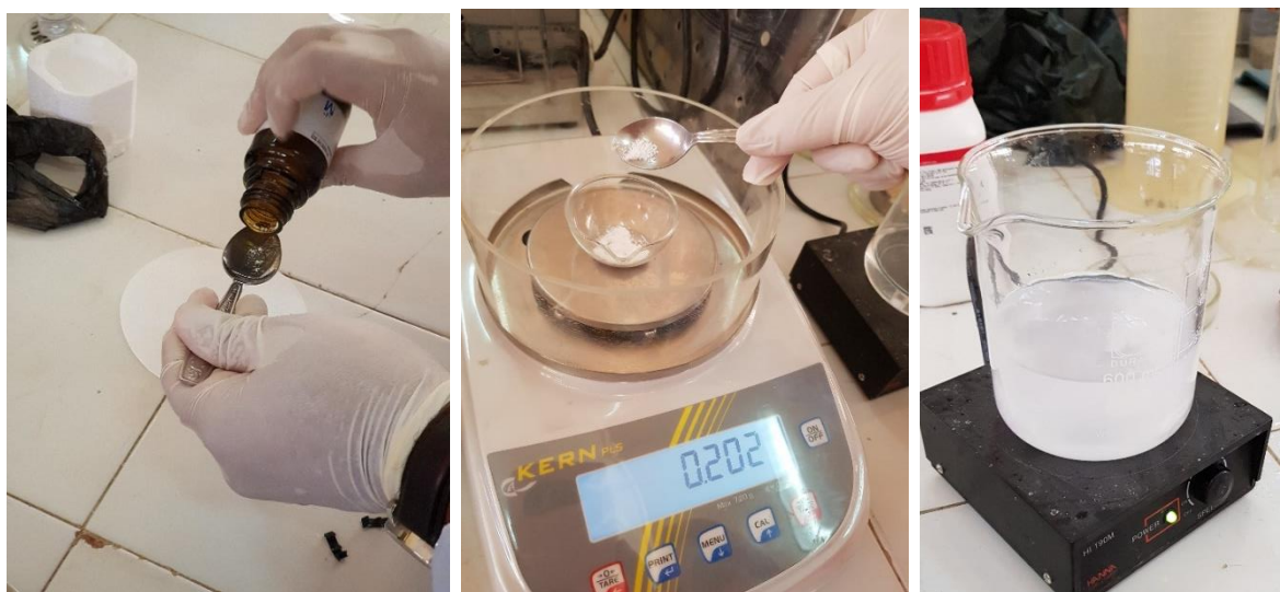
Figure 2-17 : préparation la solution enzymatique
