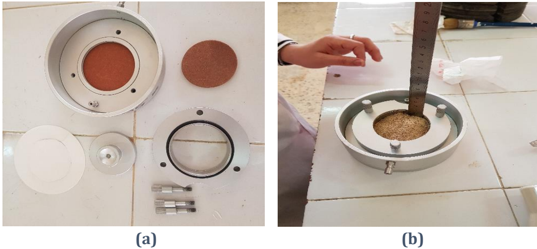
Figure 2-5 : préparation d'échantillon de sable avant le mesure de perméabilité
