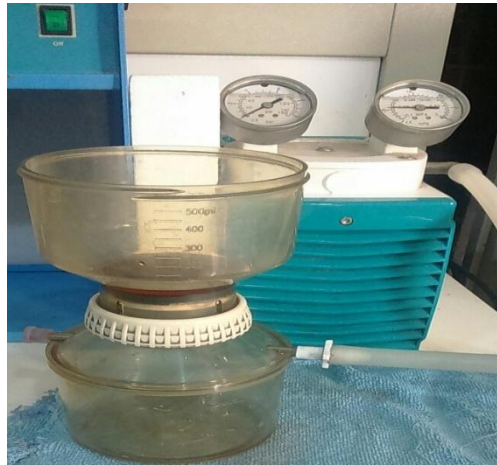
Figure 19 : Pompe de filtration sous vide
