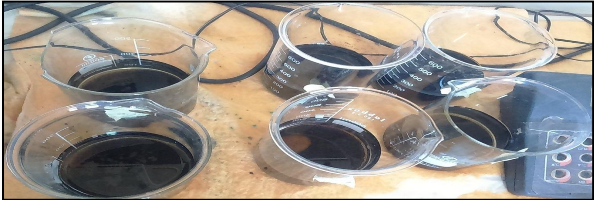
Figure 29 : Photo présente l'effet de la variation de l'adjuvant le charbon actif en poudre (CAP) le coagulant (Sulfate d'aluminium)
