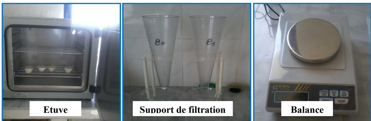
**Figure 36** : Les différents appareils de détermination des matières en suspension (Cliché par ZORAI, 2019).
