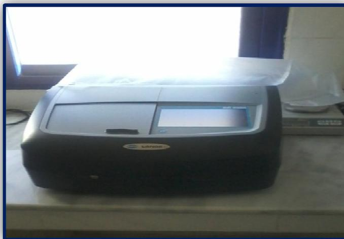
**Figure 39** : Spectrophotomètre (DR6000) (Cliché par ZORAI, 2019).
