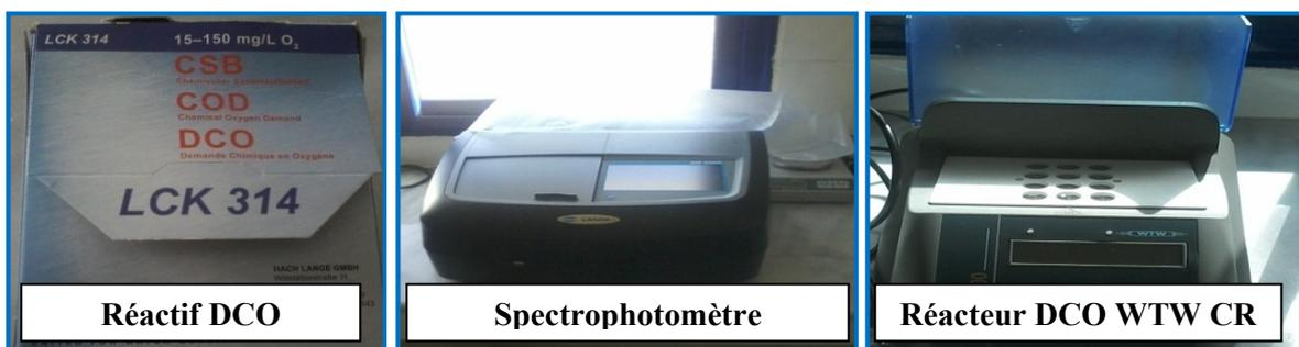
**Figure 37:** Appareils et réactifs pour la détermination de la DCO
