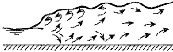
Figure 1.2.2 : Le ressaut de transition ou oscillatoire[3]
