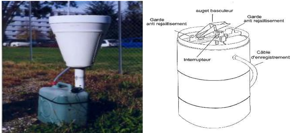
Figure N°7 : Pluviographe à augets, avec bidon de récupération de l'eau captée par l'impluvium (photo J.-L. Bertrand-Krajewski)
