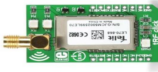
**Fig. III.9 : Le module RF choisi (TRF click)**
