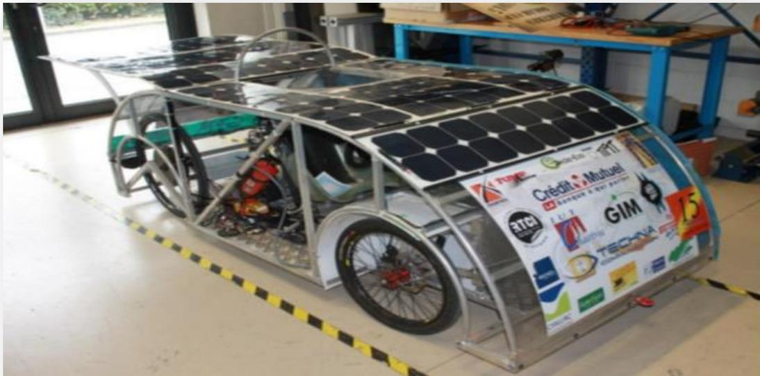
**Fig. I.3 : Le véhicule électro solaire**
