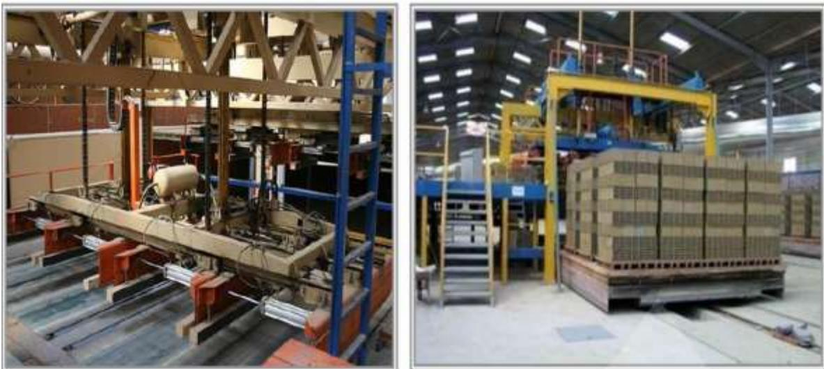
Figure I.8 : Empilage brique sortie séchoir
