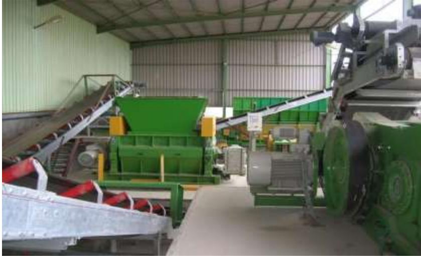
Figure I.3 : Broyeur
