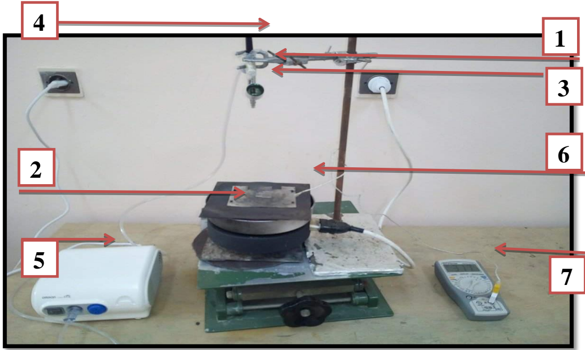
الشكل (1.III): التركيب التجريبي لترسيب الاغشية الرقيقة بتقنية الرش بالانحلال الحراري.
