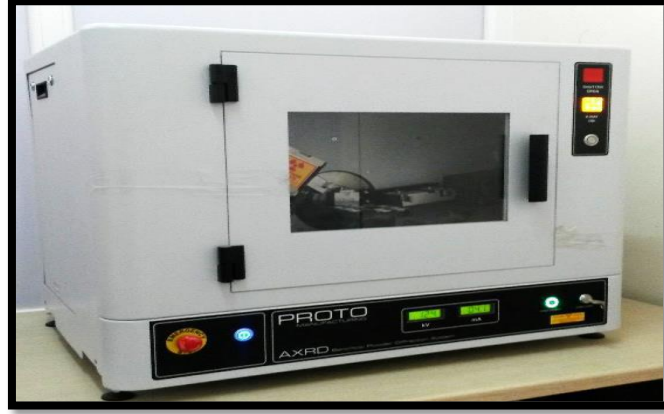
الشكل (12.II): جهاز انعراج الاشعة السينية (XRD) المستخدم [24].
