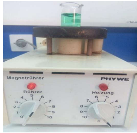
-عملية رج المزيج فوق الخلاط المغناطيسي.
