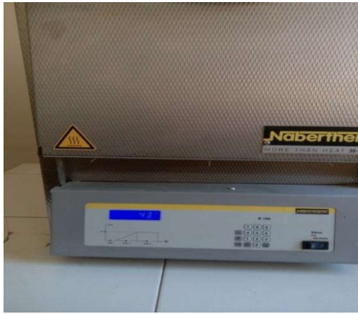
-الفرن الكهربائي المستعمل في التلدين.
