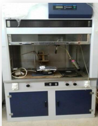
الشكل (III.1): صورة من الاعداد التجريبي للرش بالانحلال الحراري.
