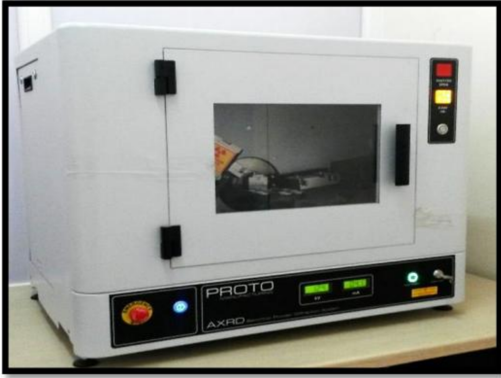
الشكل (12.II): جهاز انعراج الاشعة السينية (DRX) المستخدم [28].
