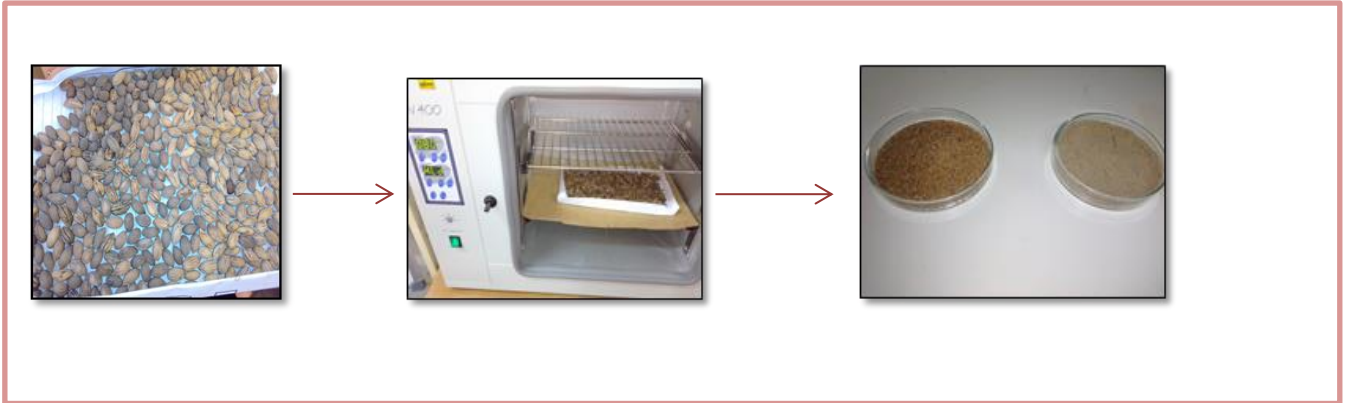
Fig.III.2 : les étapes de préparation fibre noix d'olive
