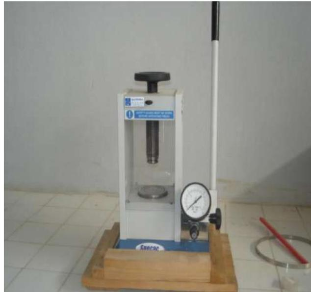
Figure II.11 : Appareil de pressage uniaxial
