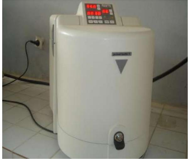
Figure II.10 : Broyeur planétaire (Fritsch P6).
