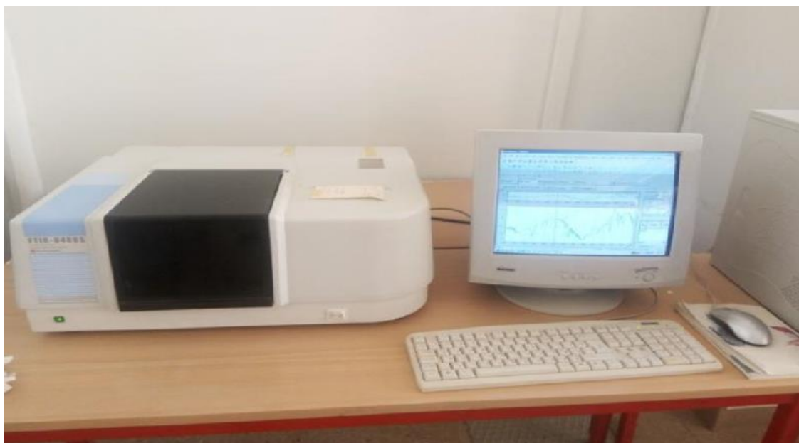
Figure 26: Spectrophotomètre à transformée de Fourier de type SHIMADZU FTIR-8400S.
