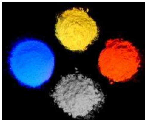
Figure I.3: Phosphores sous excitation, luminescence bleu ( \text{Eu}^{2+} ), vert ( \text{Tb}^{3+} ) et rouge ( \text{Eu}^{3+} ) [7].
