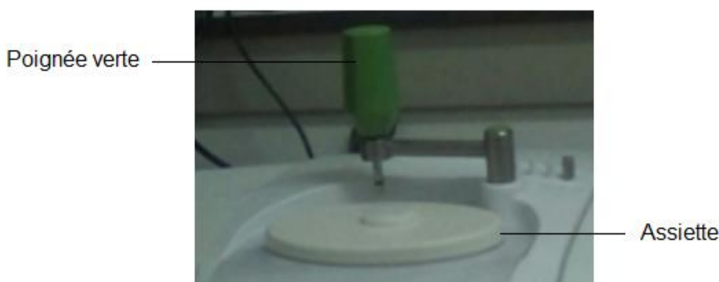
Figure II.10 : Mise en place de l'échantillon.
