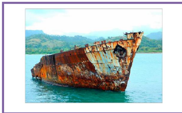
Fig (I.1) : la Corrosion généralisée (uniforme). [6]
