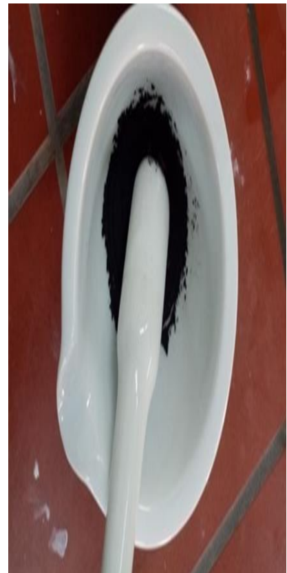
Figure III.8 : Poudres obtenus après la calcination à 950°C
