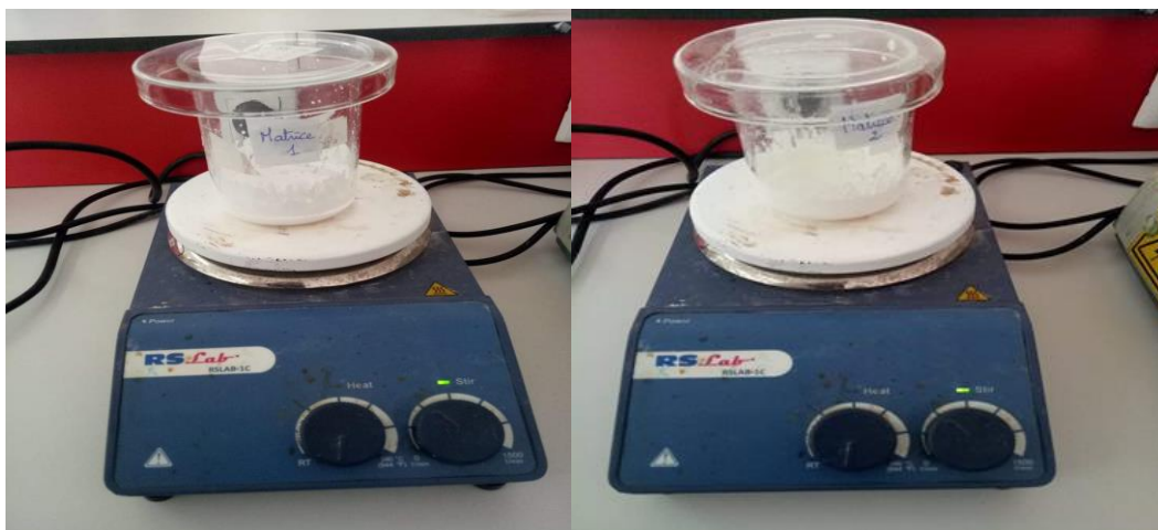
Figure III.3: Agitation par un agitateur magnétique.
