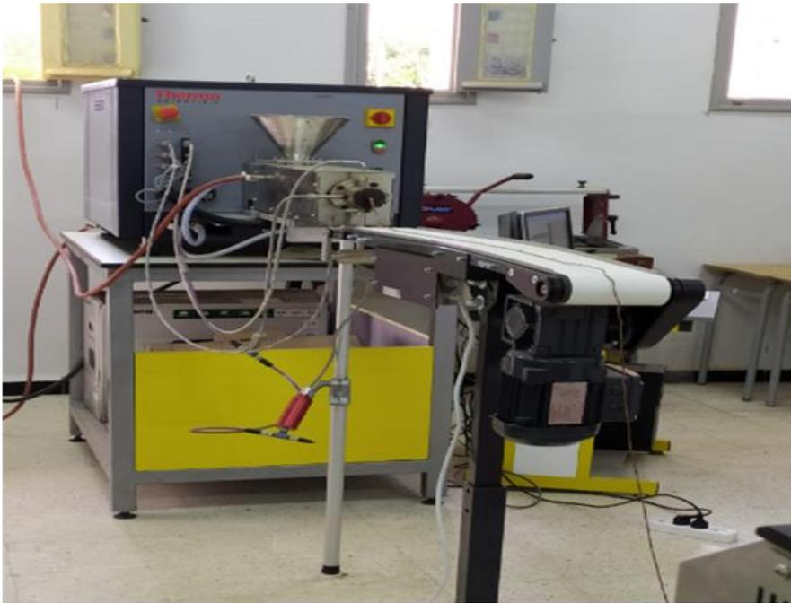
**Figure II.6** : Extrudeuse de type PolyLab OC
