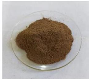
**Figure II.5 :** Fibres de palmier après le traitement de dichromate de potassium
