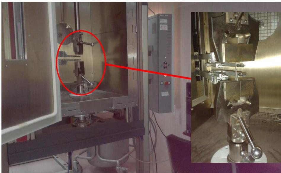
**Figure II.10 :** La machine de traction utilisée.
