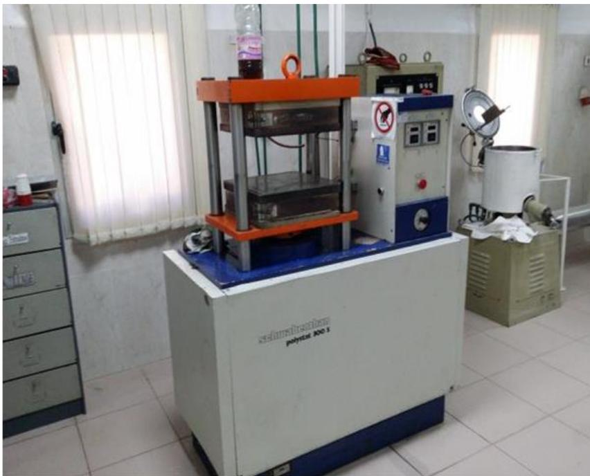
**Figure II.8** : La presse utilisée (SCHWABENTHAN POLYSTAT 300S)
