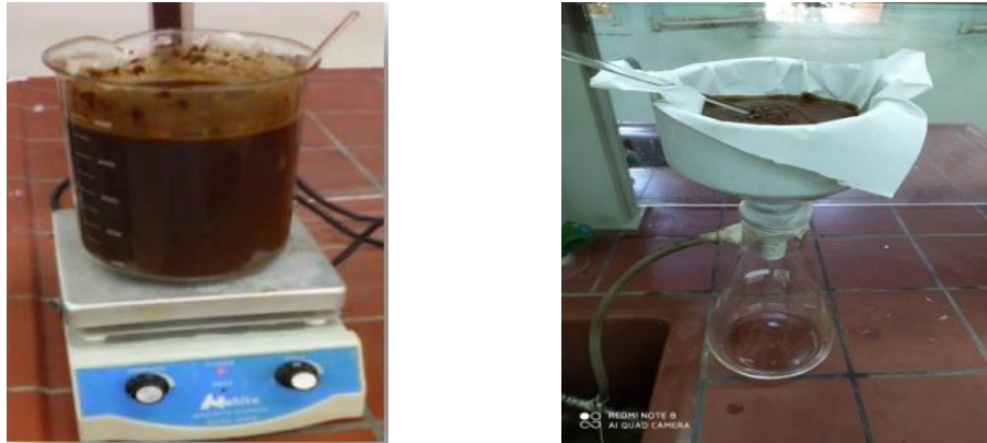
Figure II.3: Traitement des fibres de palmier par mercerisation
