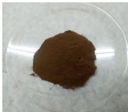
Figure II.4 : Fibres de palmier après le traitement de dichromate de potassium
