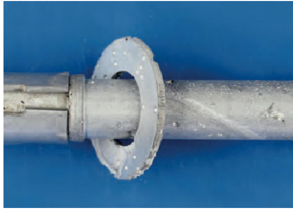
Figure I.4 : Exemple de corrosion par piqûre sur un produit en acier inoxydable [15]
