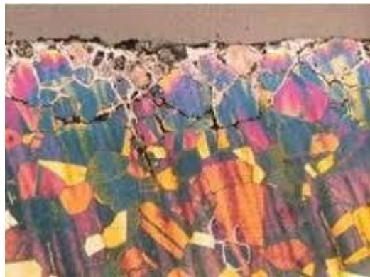
Figure I.5: Corrosion inter granulaire d'un inox par HCl [14].
