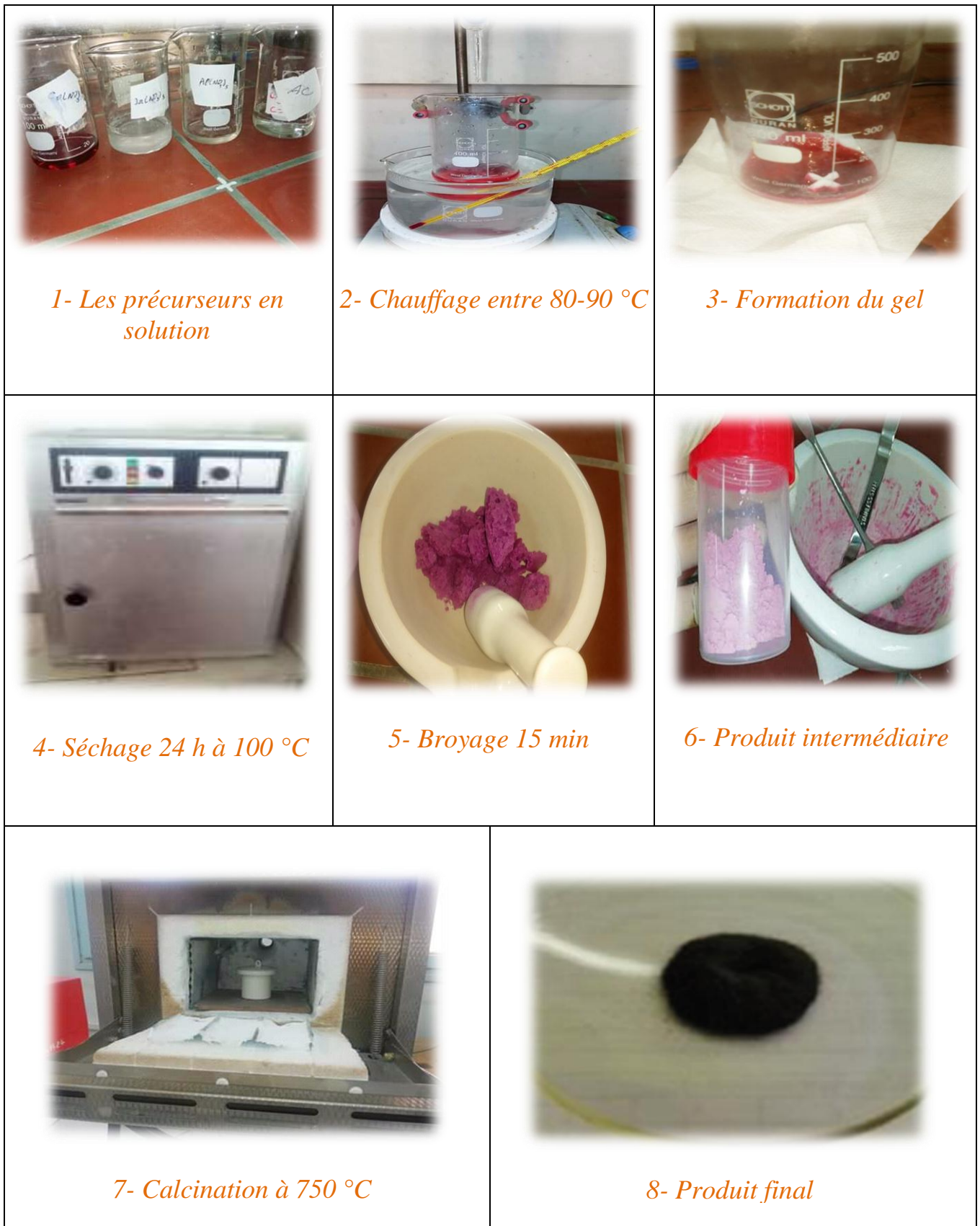
Figure III.6: Les différentes étapes de préparation de la poudre \text{LaCo}_{1-x}\text{Al}_x\text{O}_3 par la méthode sol gel.
