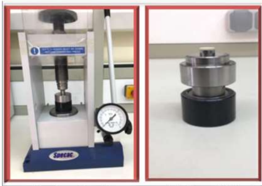
Figure (II-9) : La presse et le moule utilisée pour la préparation des pastilles.
