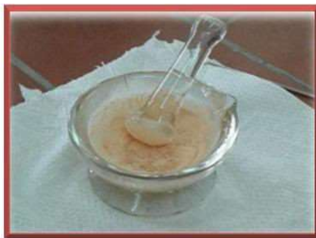
Figure (II-8) : Rebroyage après la calcination.
