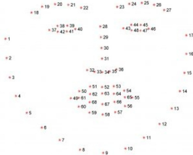
FIGURE 3.4 – Le résultat de détection des points caractéristiques à partir du visage en utilisant dlib[22].
