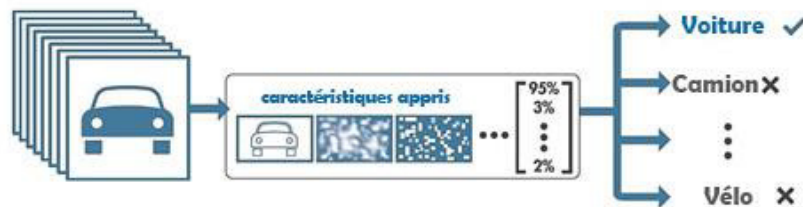
FIGURE 2.2 – Un processus de Deep Learning : les images sont transmises à un réseau, qui apprend automatiquement les caractéristiques et classe les objets.[49]
