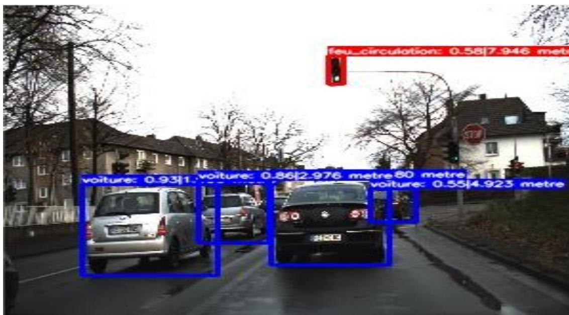
**Figure 4. 12.** La détection des objets et l'estimation de distance dans la première situation.
