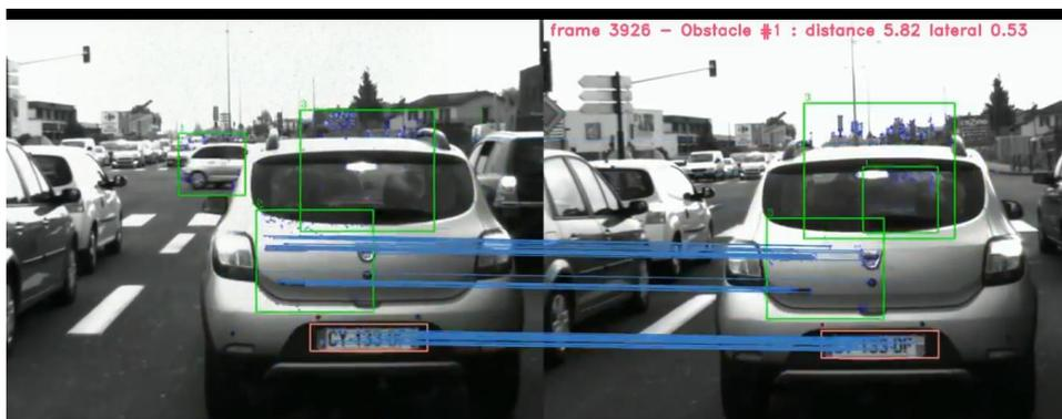
**Figure 2. 3.** Une image de caméra stéréoscopique [35].
