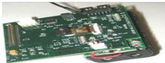
Figure 1.17: *Cyclops* connecté à un capteur *Mica2*
