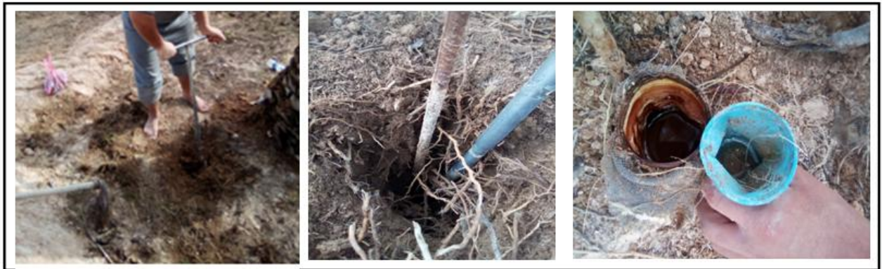
Fig17 : Dispositif expérimental pour la récupération des eaux lixivie.
