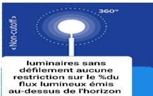
Figure 33 : luminaire sans défilement.
