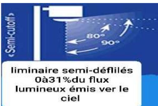
Figure 35 : luminaire semi-défilé.
