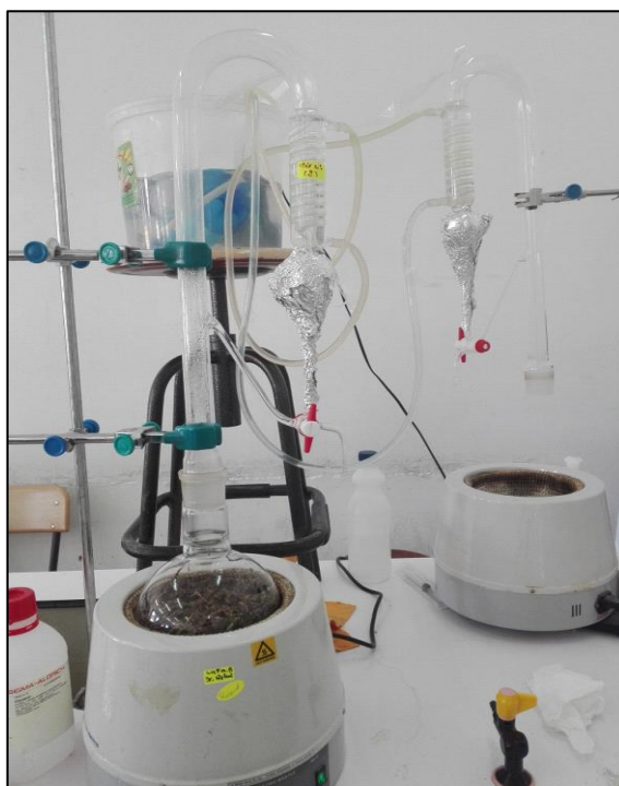
Figure 3 : Extraction des huiles essentielles de Lavandula dentata
