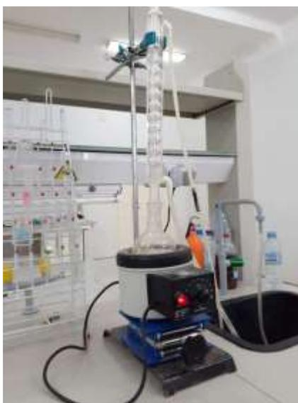
**Figure 5** : Montage à reflux.
