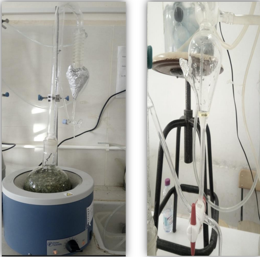
Figure 6. Montage de l'hydro distillation de type (Clevenger 1928) (Photo originale).
