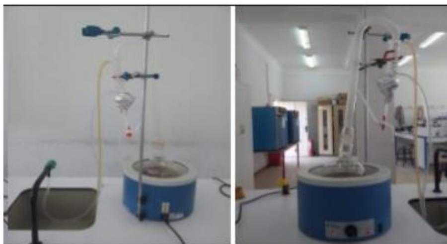
**Figure 3.** L'appareil d'extraction des huiles essentielles par hydro distillation « Clevenger ».
