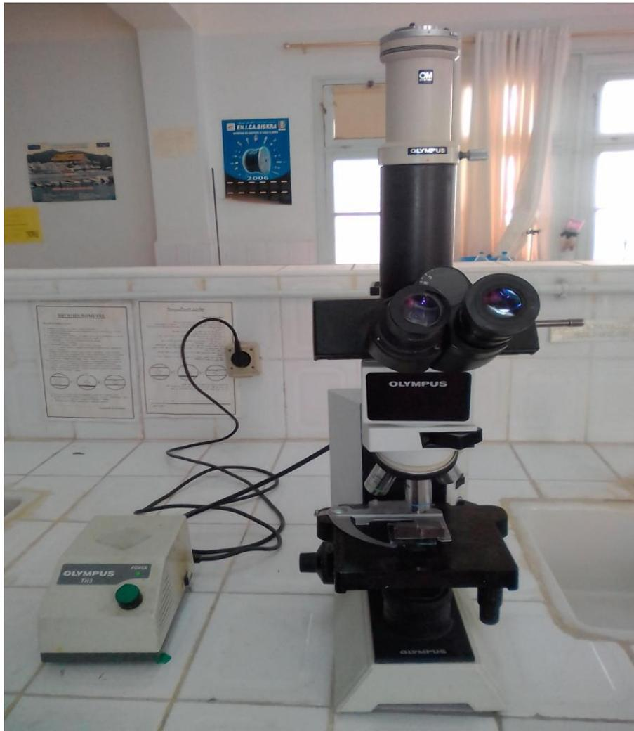
**Figure III.8 :** Microscope optique de type (Olympus BX J1M).
