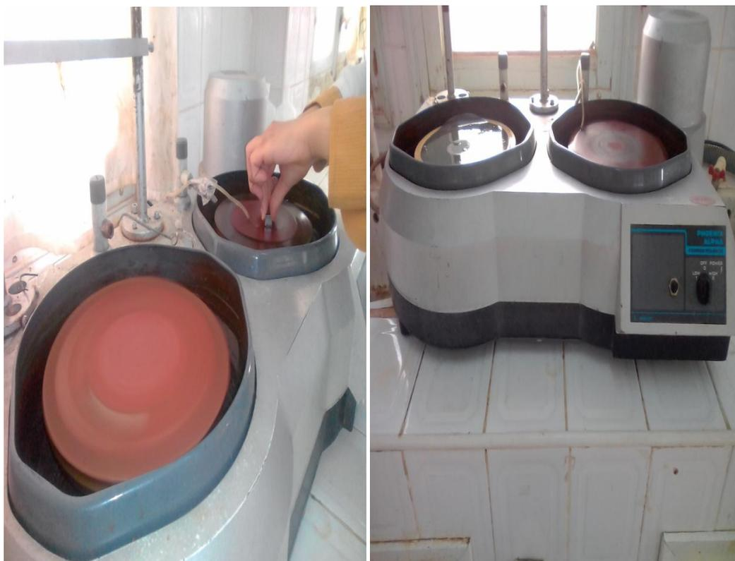
**Figure III.6 :** Polisseuse PHOENIX ALPHA d'ANALIS.
