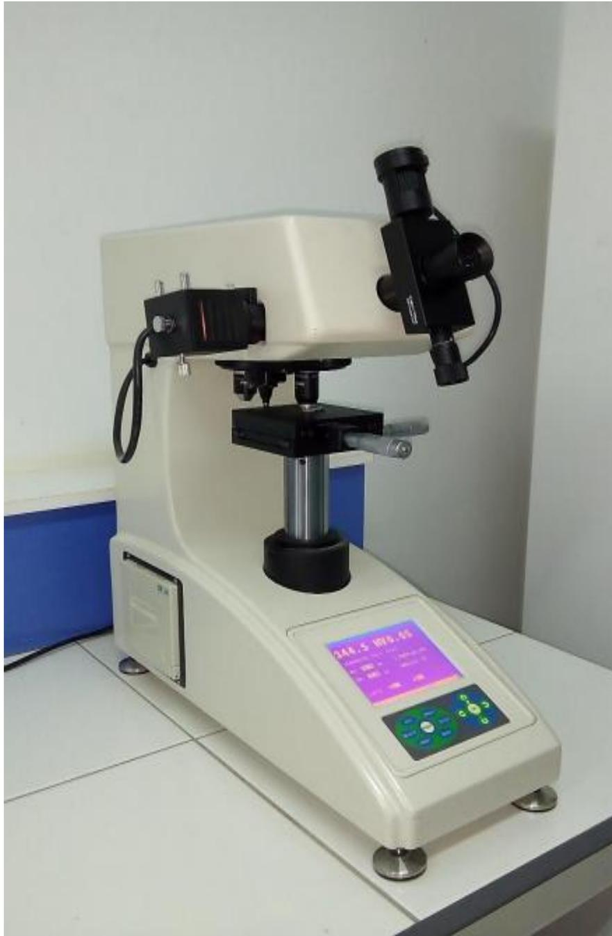
**Figure III.9** : Microduromètre Wolprt Wilson instruments.
