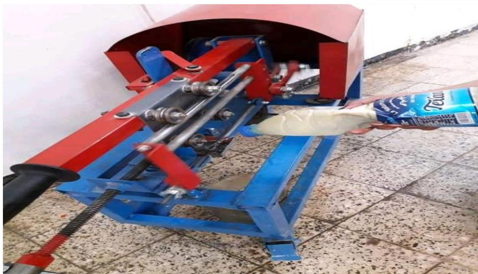
**Figure III.2 :** découpage de pipe soudé par un scie électrique.
