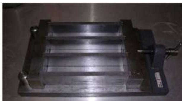
**Figure III-16 : Moule des mortiers.**
