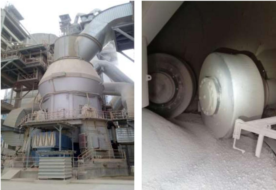
**Figure II-3 :** Broyeur à meules verticaux(VRM).
