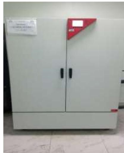
**Figure III-18** : Armoire humide.
