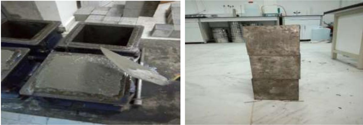
**Figure III-23** : Préparation des éprouvettes.
