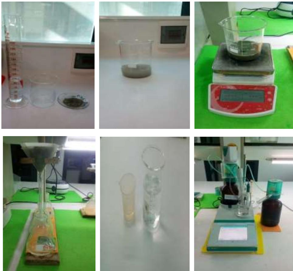
**Figure III-1** : Etapes de la détermination de chlorure.
