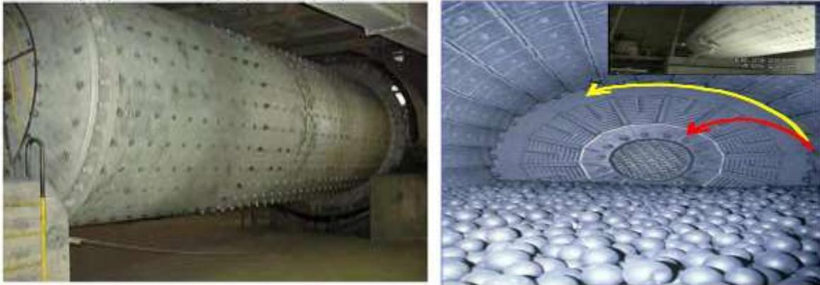
**Figure II-8 :** Broyeur à boulet [59].
