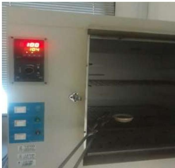
**Figure III-3** : Etuve de séchage.
