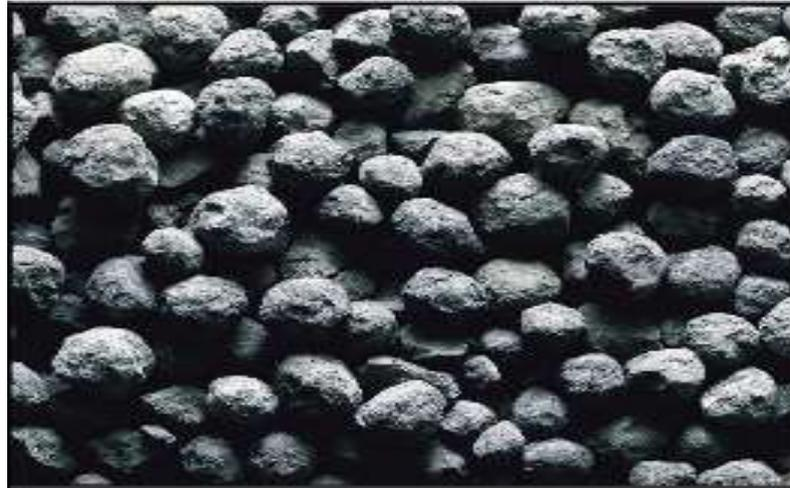
**Figure I-4** : Nodules de clinker de taille environ 20 mm [38].
