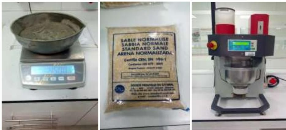
**Figure III-15 : Malaxage d'un mortier.**
