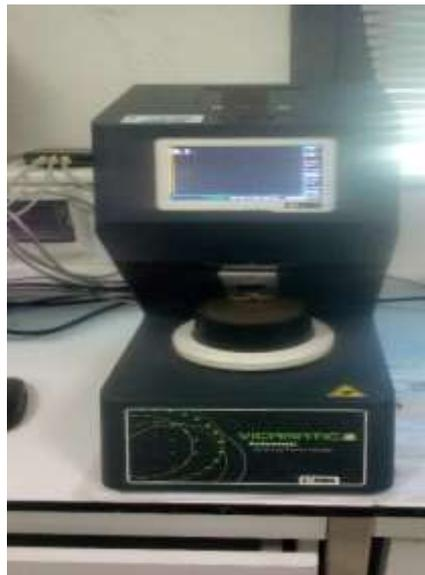
**Figure III-12 :** Appareil de vicat automatique.
