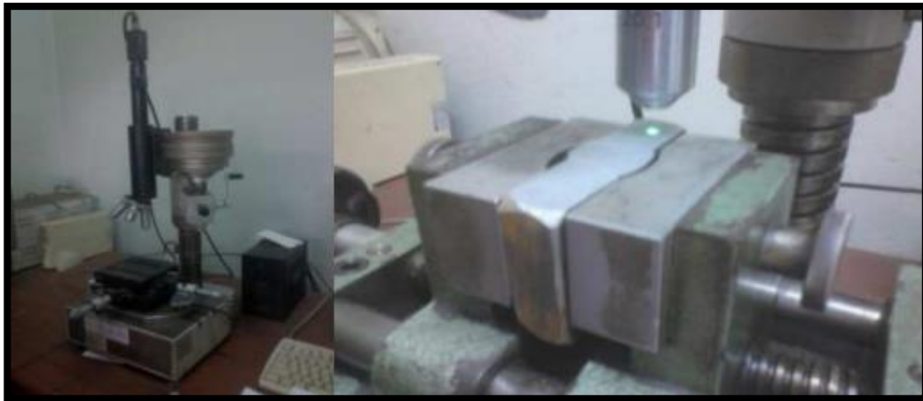
Figure III.8 : Procédure et machine de dureté (Type Vickers) [Bou15].
