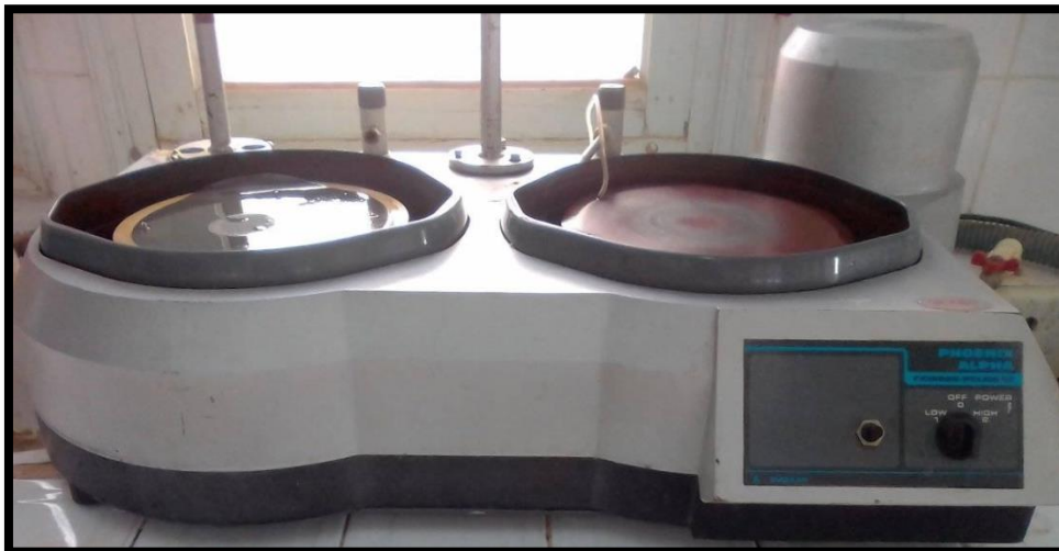
Figure IV.5 : Polisseuse de type PHOENIX ALPHA de marque ANALIS.
