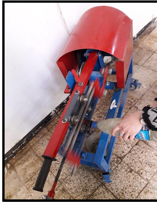
Figure IV.4 : Appareil de découpage : scie électrique.
