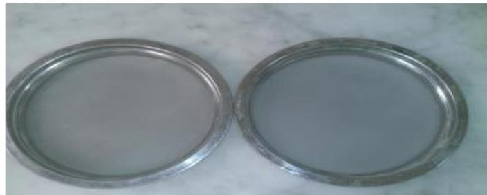
**Figure.II.5** : les tamis de 90 $\mu$  et de 45 $\mu$
