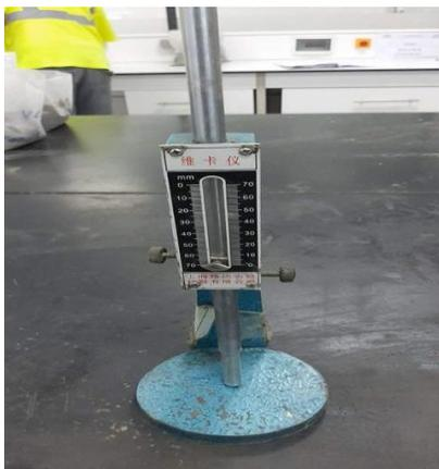
**Figure.II.7 :** Appareil de Vicat
