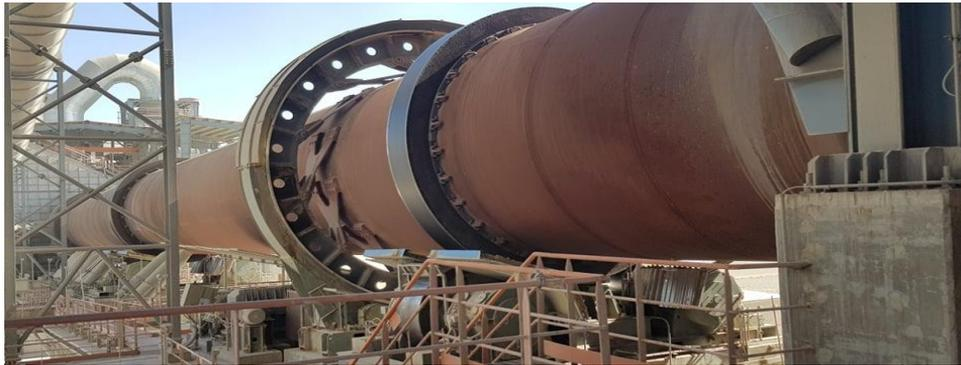
**Figure I.20 :** Le Four rotatif
