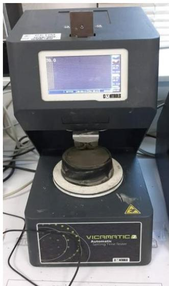
**Figure.II.8** : l'appareil de Vicat (auto)
