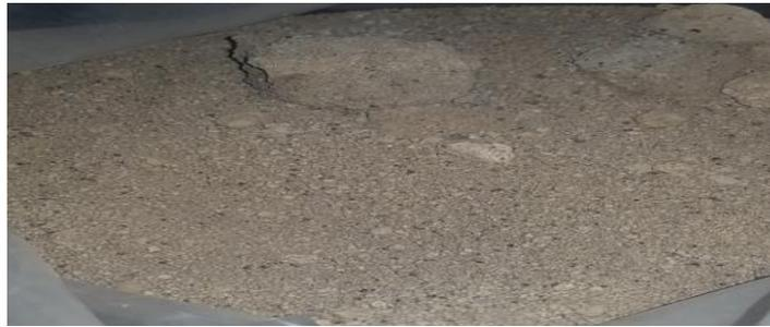
**Figure I.9 :** Le laitier
