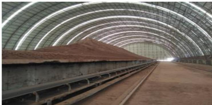
Figure I.16 : Pré-homogénéisation
