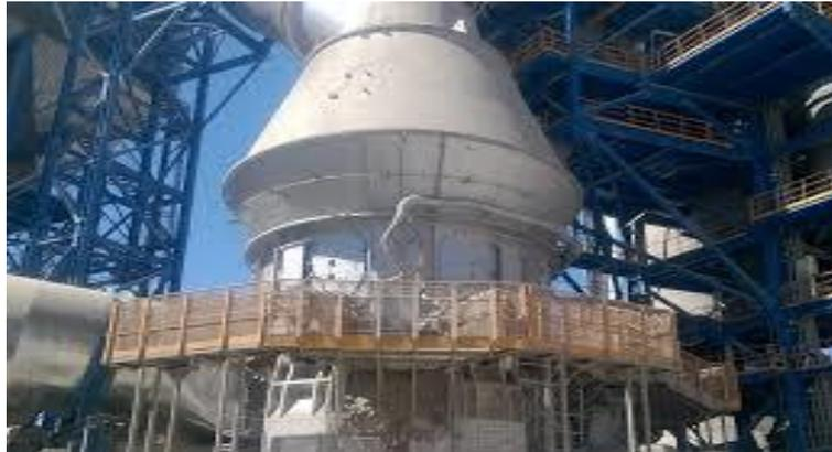
**Figure I.17 :** Le broyeur de cru (VRM)
