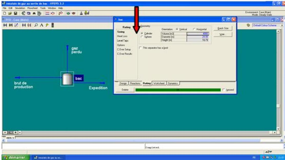
Figure IV.5: interface de choix de réservoir (TANK) dans le simulateur HYSYS
