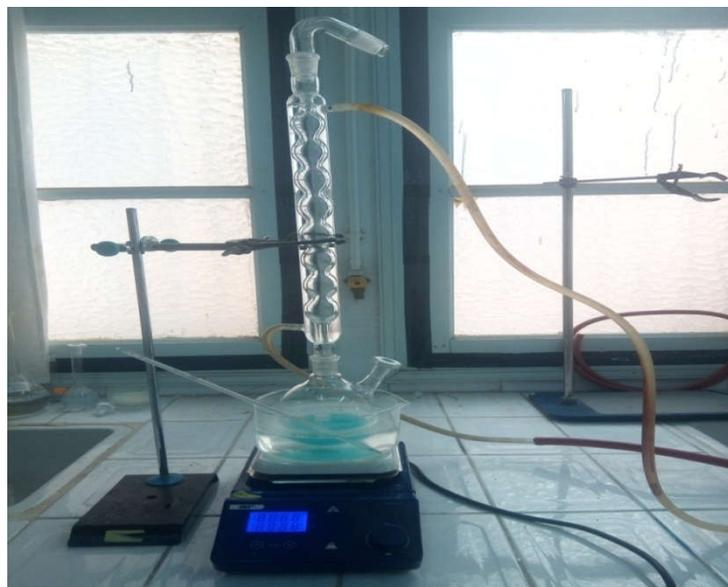
**Figure III.1** : Synthèse à reflux du cuivre.
