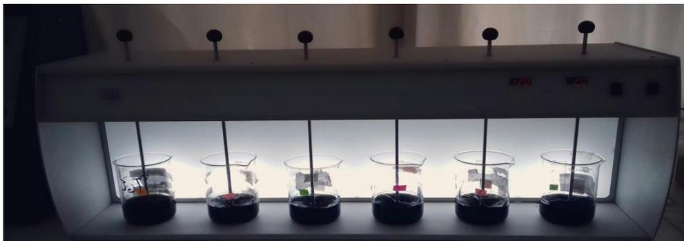
**Figure III.13 :** Agitateurs (J'ar teste)
