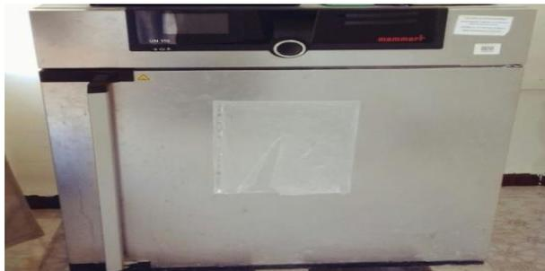
**Figure III.2:** Séchage des noyaux de datte dans l'étuve.
