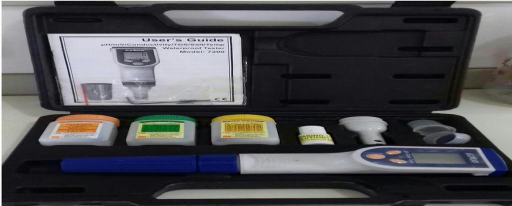
Figure III.8 :l'appareillé pH mètre, type CONSERT(multé paramètre analysé).
