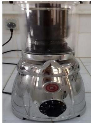
Figure III.4: broyage des noyaux de datte.
