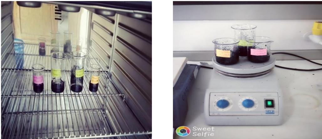
**Figure III.6:** Agitation le charbon et Séchage dans l'étuve.
