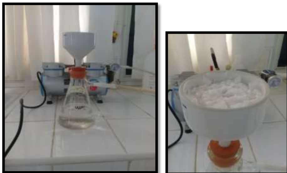
Figure II.4. La technique de la filtration sous vide utilisée.
