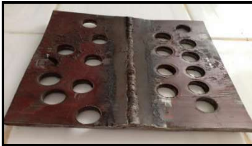
Figure II.13. L'apparence de tôle X42 après le découpage.
