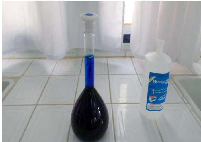
Figure III.4. La solution mère de bleu de méthylène utilise pour l'adsorption avec le charbon actif.
