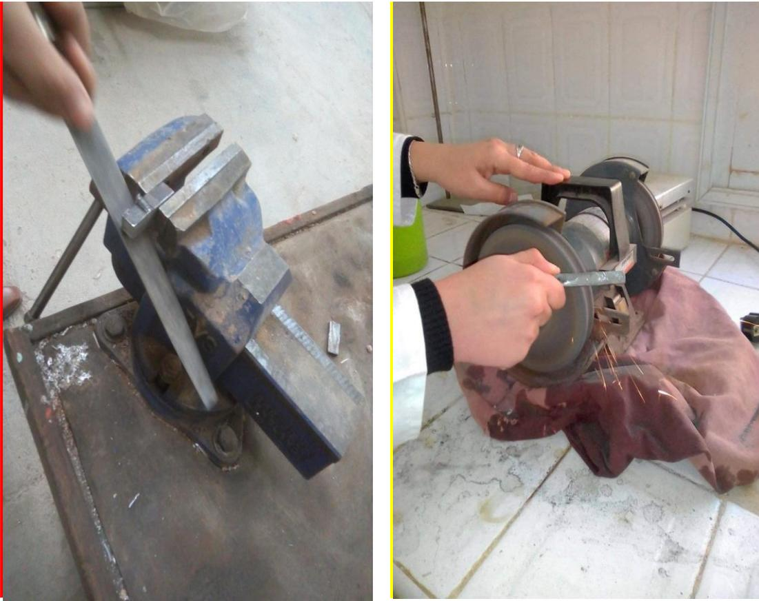
Figure III.4 : Lissage des échantillons.
