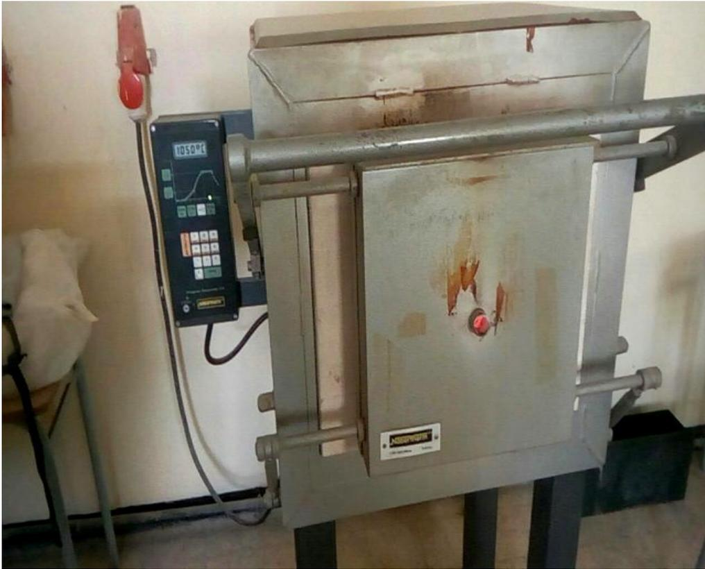
**Figure III.5 :** Four électrique.
