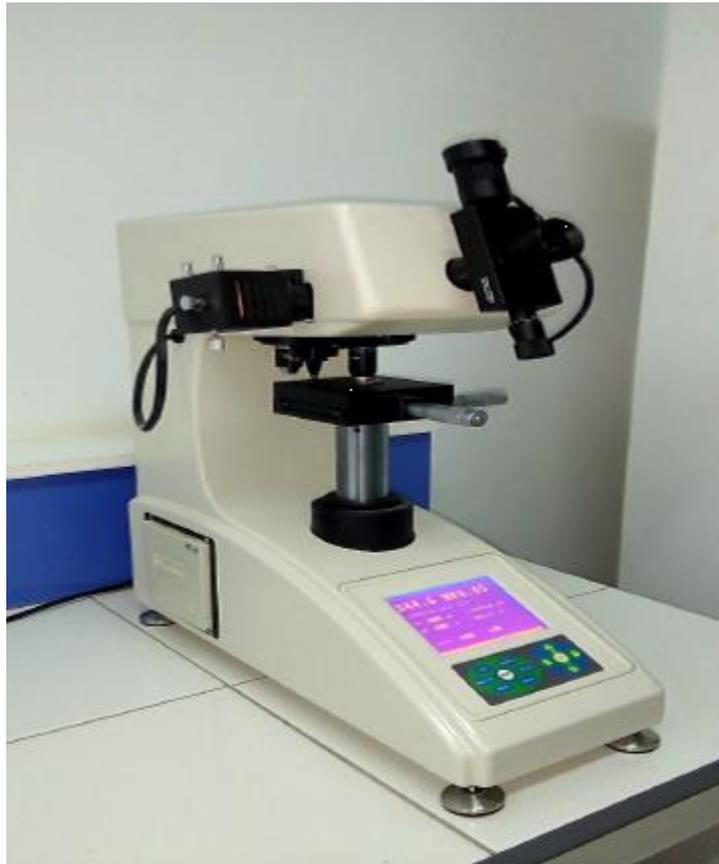
**Figure III.8** : Microduromètre [2].
