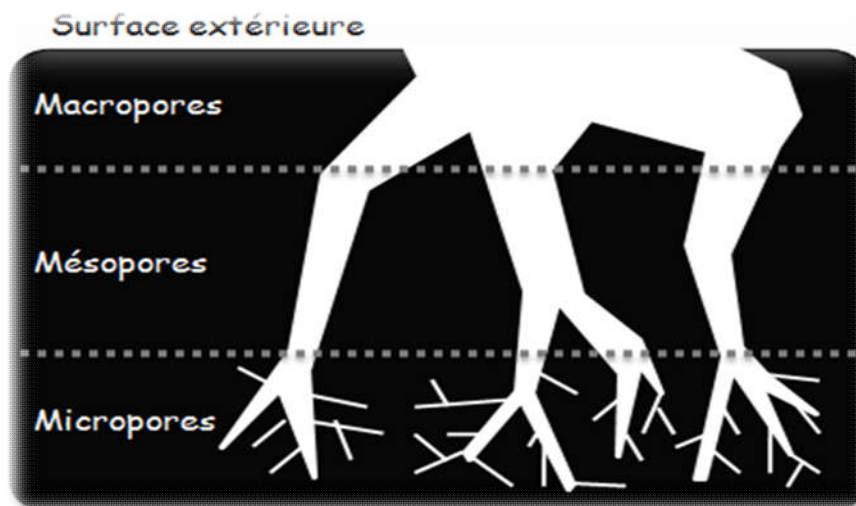
Figure II.6 : Représentation schématique de la structure des pores d'un charbon actif obtenu par activation chimique.
