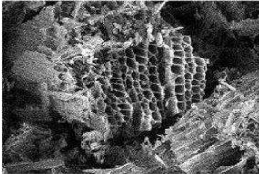
Figure II.1 : Structure du charbon actif vu sous un microscope électronique.
