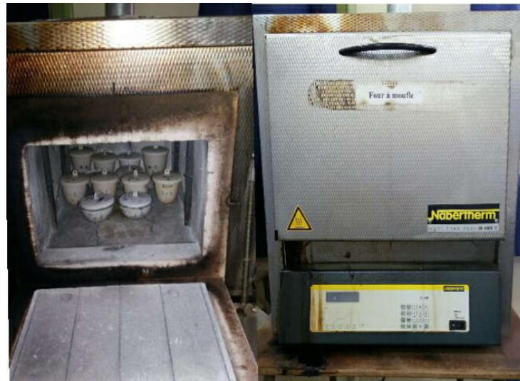
Figure III.10 : Four à moufle et Les creuser utiliser dans l'activation du noir de carbone.
