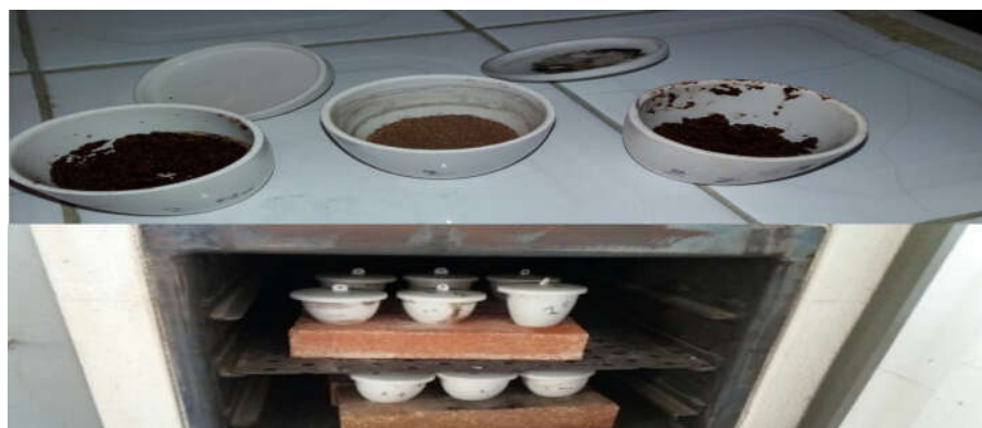
Figure III.5 : Procédé présente de l'activation du charbon.
