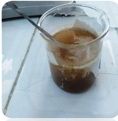
**Figure III.9 :** Les fibres de palmier dattier traité immergé dans une solution d'acide sulfurique.
