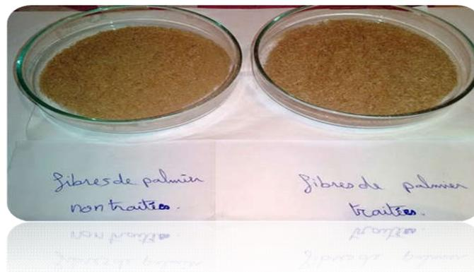
Figure III.2 : Fibres de palmier dattier (traitées et non traitées).
