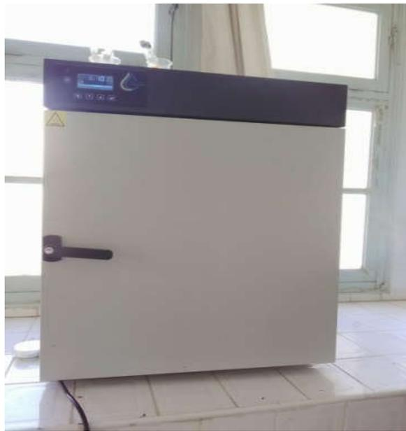
**Figure III.11 :** Les fibres de palmier traitées dans l'étuve pour le séchage.
