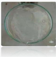
**Figure III.16 :** Film bioplastique sans charge organique après le séchage.
