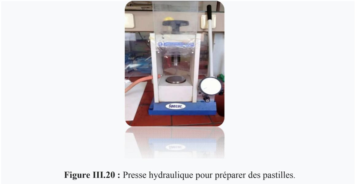
Figure III.20 : Presse hydraulique pour préparer des pastilles.
