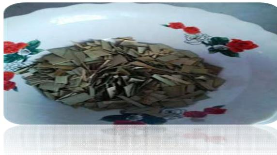
**Figure III.5 :** Fibres de palmier divisées en petits morceaux.
