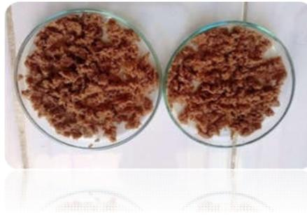
**Figure III.10 :** Fibre de palmier traité avant le séchage.
