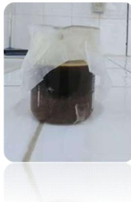
**Figure III.7 :** Les fibres de palmier dattier immergés dans une solution d'hydroxyde de sodium.
