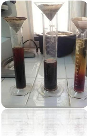
**Figure III.8 :** Lavage des fibres de palmier avec l'eau distillé après plusieurs fois.
