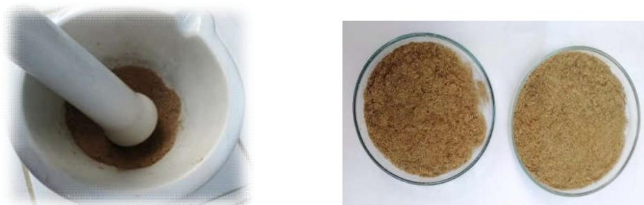
**Figure III.12 :** Fibres de palmier dattier traité après le séchage et broyer ces fibres.
