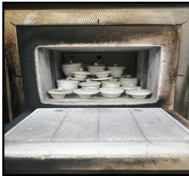
Figure II.4: Les creuser dans le four à moufle.
