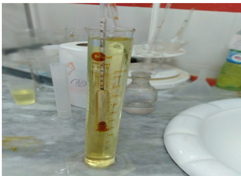
Figure III.4 : Aréomètre normalisé selon la norme ISO 650.
