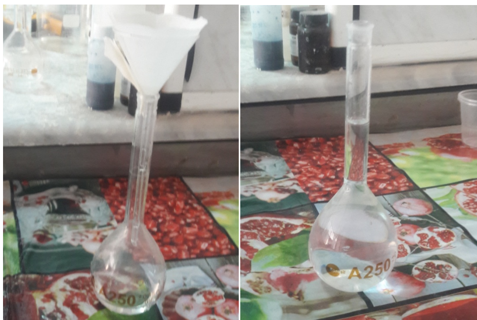
Figure : Filtration de la saumure
