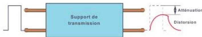
*Figure I-3: Atténuation du signal par le support de transmission*
