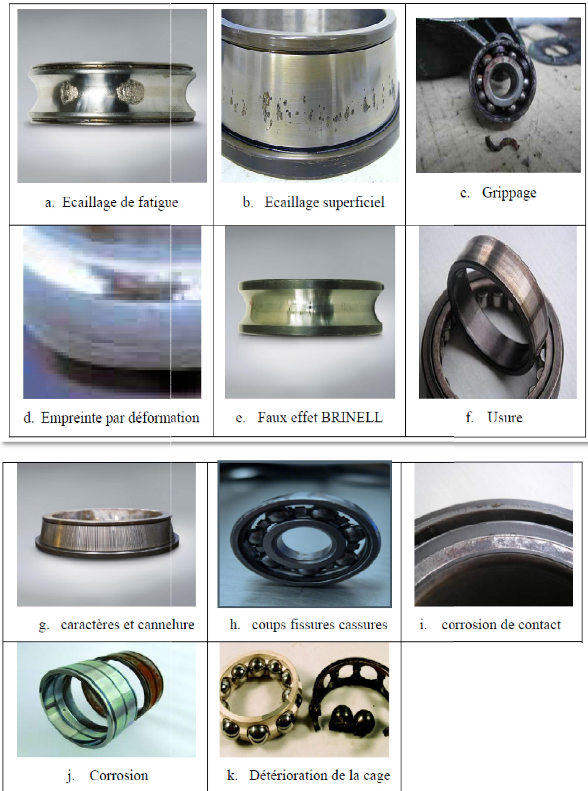
Figure I.7 : Les différents types d'anomalies qui surviennent sur les roulements.
