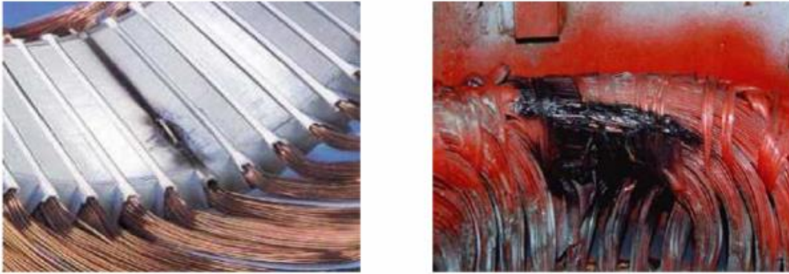
Figure .II. 6 Exemple de dégâts dus au défaut de court-circuit statorique d'un moteur asynchrone [19].
