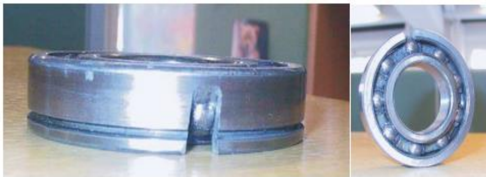
Figure .II. 5 Un exemple réel d'un problème d' roulement [15].
