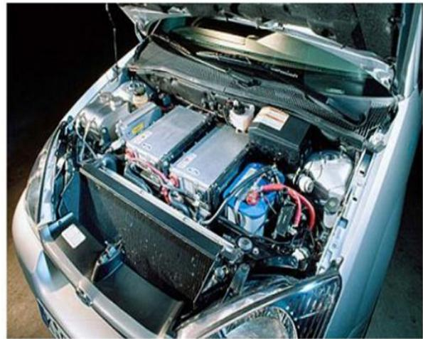
Figure 1.9 : Pile Ballard Mark 90 véhicule Ford
